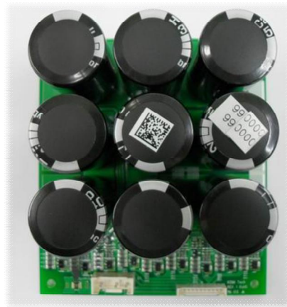
그림 1 신재생에너지용 EDLC 모듈(3V, 350F) Fig. 1 EDLC Module for Renewable Energy System
